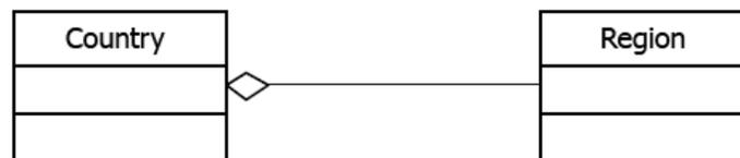
**Gambar 2.13 - Hubungan agregasi di antara dua class**
